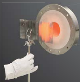
パンチングプレートを瞬時に加熱
