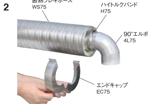
断熱フレキホースの外側ホースを引っ張り、エンドキャップを広げて、断熱フレキホースの外側ホースにかぶせてください。このとき、エンドキャップの内径部が断熱フレキホースの内側ホースにかからず、配管部に接触するようにはめ込んでください。
