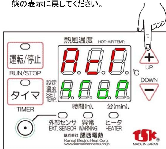
この設定により、停電等の瞬停後、元電源が再投入されても、マルチドライヤは自動的に運転は再開されず、停止状態となります。手動にて再運転を開始してください。
