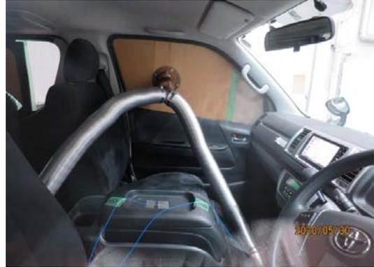
後部トランクルームも2分岐部から熱風を回収し、100%熱風循環
