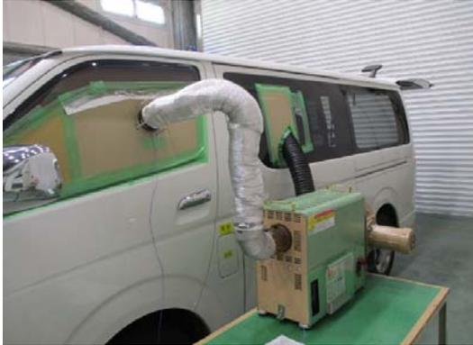
熱風供給口を2分岐し、フロントシートと2列目シートに熱風を吹き出し
